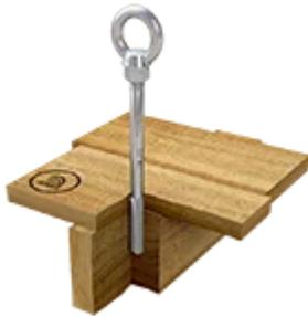
Unkomplizierter geht es kaum: Für den Einbau des Sekuranten ABS-Lock III-H bohren Sie einfach ein Loch. Dann schrauben Sie das untere Gewinde des Anschlagpunkts direkt in den Sparren. Nach der Montage sichert die Anschlagvorrichtung bis zu 3 Personen gegen Abstürze - als Rückhaltesystem oder als Auffangsystem auf Ihrem Flachdach.
