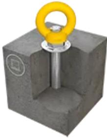
Der ABS-Lock III-R ist eine frei drehbare Edelstahl-Anschlageinrichtung für Wand, Boden, Fassade oder Montage über dem Kopf. Das 80 mm lange Gewinde (M16) des ABS-Lock III-R wird mit unserem Verbundmörtel WIT-VM-250 (ZU-1000) direkt im Beton befestigt. Dank der drehbaren Öse bewegen Sie sich komfortabel um den zentralen Anschlagpunkt, ohne dass Ihr Verbindungsmittel sich verdreht oder Ihr Karabinerhaken verkantet.
