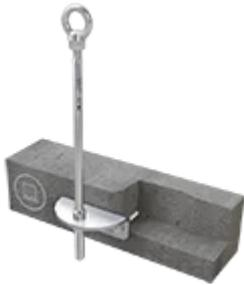
Der Anschlagpunkt ABS-Lock III-SEITL-65 zum Einbetonieren hat eine Winkelplatte für die seitliche Montage. Seine 2 Ankerstangen werden mit unserem Verbundmörtel WIT-VM-250 (ZU-1000) im Untergrund befestigt. Der Anschlagpunkt sichert nach fachgerechter Montage bis zu 3 Ihrer Mitarbeiter gleichzeitig an Absturzkanten.
