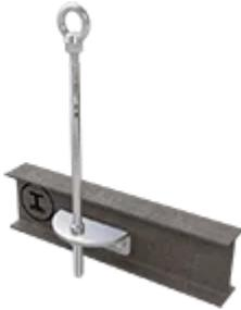
Eine zuverlässige Anschlageinrichtung für 3 Personen: Das ist der ABS-Lock III-Seitl-65 für die seitliche Montage auf Stahl. Er eignet sich damit bestens für verschiedene Anwendungsfelder der Industrie. Der Edelstahl-Anschlagpunkt (Ø 16mm) wird mit einer Winkelplatte befestigt. Diese wird durch den Untergrund gekontert, beispielsweise durch tragende Stahlträger. Das erforderliche Befestigungsmaterial gehört zum Lieferumfang.
