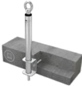
Mit ihrem verschraubten Stützrohr ( $\varnothing$  42mm) ist die Anschlageinrichtung ABS-Lock III-SEITL-SR bestens für die Nutzung in Seilsicherungssystemen gerüstet. Errichten Sie eine permanente Absturzicherung für mehrere Personen: Der in alle Belastungsrichtungen getestete Anschlagpunkt ist für die Installation auf dem Boden, an der Fassade und über dem Kopf geeignet - in Seilsicherungssystemen ebenso wie als einzelner Sekurant.
