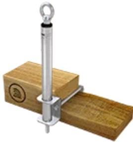
Ob als Zwischenstütze, Träger für ein Kurvenelement oder Endpunkt: Der Edelstahl-Anschlagpunkt ABS-Lock III-SEITL-SR mit Stützrohr (Ø 42mm) kann auf verschiedene Arten als Komponente in Seilsicherungssystemen verwendet werden. Die Befestigung auf Holzuntergründen erfolgt mit einer Winkelplatte, die durch tragende Balken (Sparren) gekontert wird. Durch das zusätzliche, verschraubte Stützrohr gibt der Anschlagpunkt der bei Seilsicherungssystemen notwendigen Vorspannung nicht nach.
