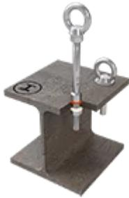
Eine 16mm starke Edelstahlstütze ist das Herz der Anschlagvorrichtung ABS-Lock III-ST. Der Sekurant kann in jede Richtung belastet werden, sichert bis zu 3 Personen bei Höhenarbeiten und ist auf Wunsch auch ohne Überstand lieferbar.
