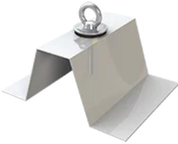
Unkomplizierter geht es kaum: Der Edelstahl-Anschlagpunkt ABS-Lock VI zur Befestigung der persönlichen Schutzausrüstung gegen Absturz (PSAgA) wird mit nur einem Kippdübel montiert. Nach der Installation sichert der hochwertige Anschlagpunkt eine Person bei Arbeiten auf dem Sandwich- oder Trapezblechdach zuverlässig. Die Anschlageinrichtung ist gemäss DIN EN 795 für die Nutzung in jede Belastungsrichtung geprüft.
