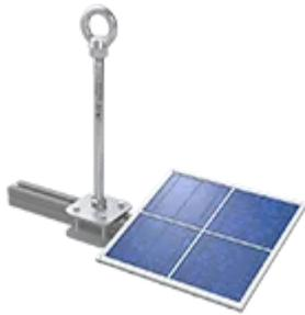
Einfach um die Träger Ihrer Solarthermie- und PV-Module geklemmt, bietet der ABS-Lock X-Solar für 3 Personen einen Anschlagpunkt. Der Anschlagpunkt kann sowohl als Einzelanschlagpunkt genutzt oder zu einem Seilsicherungssystem erweitert werden.
