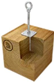
Die Anschlageinrichtung ABS-Lock X-H-4 wird mit den 4 beigefügten Edelstahlschrauben direkt im tragenden Balken verschraubt. Die Stütze des Anschlagpunkts hat einen Durchmesser von 16 mm, die Grundplatte ist 100 x 100 mm groß. Die Absturzsicherung ist für eine Belastung in alle Richtungen konzipiert und hält 3 Personen.
