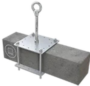
Eine starke Stütze, auch über Kopf - der Anschlagpunkt ABS-Lock X-Klemm wird mit seiner Grund- und Konterplatte um Betonträger geklemmt. Fachgerecht montiert sichert er bis zu 3 Ihrer Mitarbeiter zeitgleich, und das in jede Richtung. Durch diese Eigenschaften ist die Anschlageinrichtung sehr flexibel einsetzbar. Am Boden, an der Wand und an der Decke.
