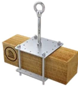
Sie wollen einen Einzelanschlagpunkt an einem Holzbalken befestigen, ohne diesen zu beschädigen? Dann ist der ABS-Lock X-Klemm die richtige Lösung. Die Anschlagvorrichtung aus Edelstahl wird mit einer Grund- und einer Konterplatte (je 200 x 200 mm) um tragende Sparren geklemmt.
