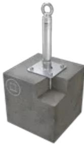
Eine starke Stütze für Betonuntergründe: Das ist der Einzelanschlagpunkt ABS-Lock X-SR-B mit Grundplatte (150 x 150 mm) und einem verschweißten Stützrohr (Ø 42 mm). Sie befestigen den Sekuranten einfach mit 4 Einschlagdübeln auf der Dachhaut oder an der Fassade. Die Einbautiefe beträgt nur 65 mm. Die Kerbung des Stützrohrs dient als Sollknickstelle und sorgt bei einer Sturzbelastung für ein genau definiertes Umknicken in Belastungsrichtung.
