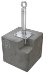
Der Anschlagpunkt ABS-Lock X-SR-B-A punktet mit seiner geringen Einbautiefe von nur 60 mm. Er wird mit 4 Ankerstangen und unserem optional erhältlichen Verbundmörtel WIT-UH-300 im Beton befestigt (Für nicht aufgeführte Betongüten erfolgt der Nachweis über Zugversuche). So sichert er gemäss DIN EN 795 und DIN CEN/TS 16415 als Sekurant bis zu 3 Dacharbeiter gegen einen tödlichen Sturz in die Tiefe.
