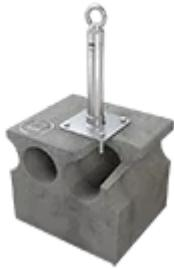
Mit 4 speziellen Hohlblechenankern (Spreizdübeln) befestigen Sie den Anschlagpunkt ABS-Lock X-SR-HD sicher auf Rippen- und Beton-Hohldecken. Der Montageuntergrund benötigt dafür eine Güte von mindestens C45/55 (B55). Sie können den Anschlagpunkt in verschiedenen Größen zwischen 300 mm und 1000 mm ordern. Der erforderliche Überstand variiert abhängig von der Dacheindeckung und dem geplanten Auffang- oder Rückhaltesystem.
