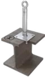
Sie benötigen einen Einzelanschlagpunkt mit 400, 700 oder 1000 mm Überstand? Mit dem ABS-Lock X-SR-ST kein Problem. Der Anschlagpunkt ist in Schritten von je 100 mm standardmäßig in den Längen zwischen 300 bis 1000 mm verfügbar. Weil die Anschlagvorrichtung mit einem verschweißten Stützrohr ausgestattet ist und durch Stahl gekontert wird, ist sie ein echtes Kraftpaket und hält 3 stürzende Personen zu gleicher Zeit.
