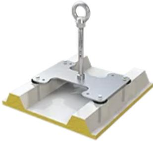
Mit dem Sekuranten ABS-Lock X-SW haben Sie eine Absturzsicherung für Sandwichdächer zur Hand, die unkompliziert von oben montiert wird. Dafür bohren Sie einfach 4 Löcher, entfernen mit einem Schraubendreher (o. ä.) etwas von der Dämmung unter der Dachhaut und stecken die Kippdübel hinein. Voraussetzung für die Montage des Sekuranten ist eine Mindeststärke der Sandwichprofile (Stahl) von 0,5 mm.
