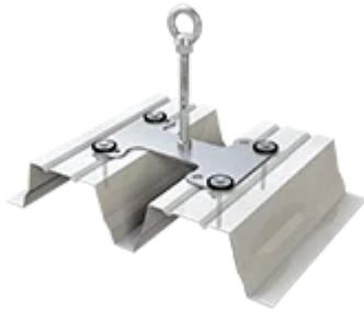
Mit dem ABS-Lock X-T-21 reduzieren Sie den Montageaufwand Ihrer Absturzsicherung. Der Anschlagpunkt wird mit 4 vormontierten Kippdübeln geliefert, die Sie ganz bequem einzeln von oben durch die Löcher der Grundplatte (290 x 200 mm) stecken. Die Absturzsicherung für Warmdächer bietet 3 Personen eine zuverlässige Anschlagmöglichkeit, die als Rückhaltesystem und Auffangvorrichtung genutzt werden kann.
