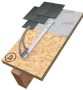
Der Sicherheitsdachhaken ABS-Lock DH04-F wird gemäss DIN EN 517:2006, Typ B als Anschlagmöglichkeit in jede Belastungsrichtung genutzt. Der Vorteil: Gesicherte Mitarbeiter können sich auch oberhalb des Anschlagpunkts in Richtung Dachfirst und darüber hinaus bewegen. Zusätzlich können sie ihre Leiter an dem Dachhaken einhängen.
