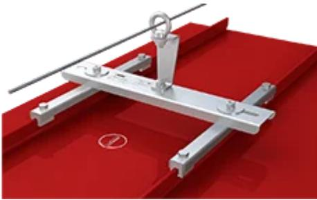
Der ABS-Lock Falz IV Klip ZW ist ein Stützelement zur Errichtung von Seilsicherungssystemen auf Metallfalzdächern. Seine Spezialklappen werden direkt auf die Schare geklemmt, sodass die Dachhaut nicht durchdrungen wird. Diese Systemkomponente ist in 2 Varianten erhältlich: Für Falzabstände von 300 bis 450 mm und für Abstände von 420 bis 660 mm.
