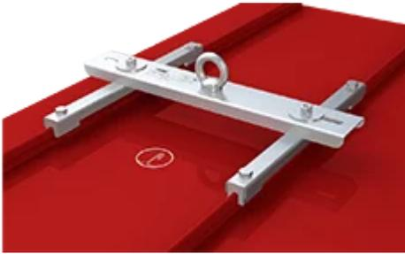
Sie suchen einen Anschlagpunkt / Sekurant für Stehfalzdächer? Dann ist der ABS-Lock Falz IV Stehfalz die Lösung. Der Sekurant wird auf dem Stehfalz festgeklemmt und ist für Dächer mit Falzabständen von 300 bis 660 mm verfügbar (z.B. Rheinzink). Der Vorteil: Die speziellen Aluminium- oder Messingklemmen durchdringen die Dachhaut nicht, das Dach bleibt daher dicht.
