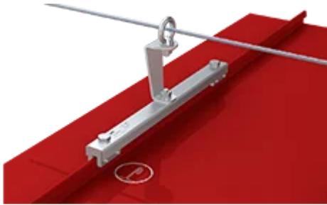
Der ABS-Lock Falz IV Stehfalz ZW findet Einsatz in Seilsicherungssystemen. Er wird dann verwendet, wenn Hindernisse überbrückt werden müssen, damit das gespannte Edelstahlseil des Seilsicherungssystems nicht aufliegt.
