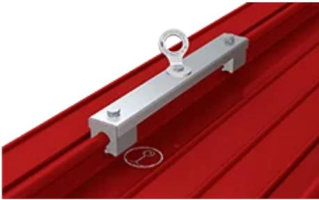
Der Einzelanschlagpunkt ABS-Lock Falz V für Rundbördelfalze sorgt mit seiner frei drehbaren Anschlagöse für Bewegungsfreiheit auf dem Metallfalzdach. Die Absturz-sicherung wird mit Spezial-Aluminiumklemmen durchdringungsfrei auf dem Rundbördelfalz (z.B. BEMO etc.) festgeklemmt.
