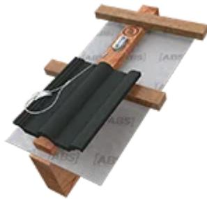
Sie suchen eine unscheinbare Alternative zum Dachhaken? Mit der Edelstahl-Anschlagschleufe ABS-Lock Loop sichern Sie bis zu 3 Personen bei Arbeiten auf dem Dach. Das Edelstahlseil ( $\varnothing$  5 mm) wird auf dem tragenden Holzsparren verschraubt und ist nach der Montage kaum zu sehen.
