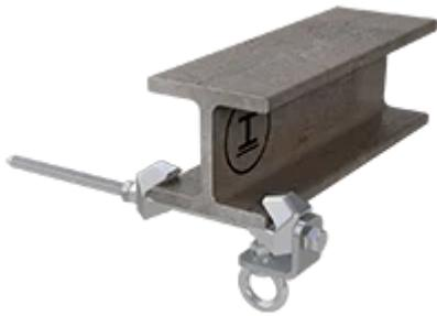
Unkompliziert montiert, fast unverwüsthlich. Der Anschlagpunkt ABS-Lock T wird mit seinen Trägerklemmen um den Flansch Ihrer Stahlträger geklemmt und kann dann flexibel als Absturzicherung verwendet werden. Der ABS-Lock T sichert als einzelner Anschlagpunkt bis zu 3 Personen, ist in jede Richtung belastbar und ausserdem als Systemkomponente in Seilsicherungssystemen sehr variabel nutzbar: als Zwischenstütze, Kurventräger oder Befestigung für Endterminals.
