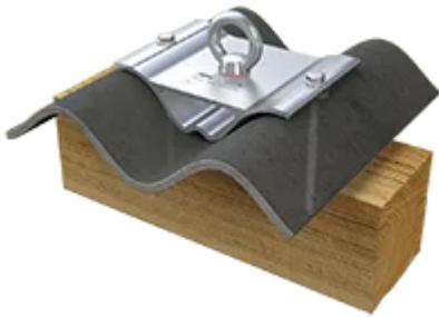
Der ABS-Lock Wave ist ein Edelstahl-Anschlagpunkt mit einer wellenförmigen Aluminiumgrundplatte. Er fügt sich optimal in die Profile von Wellplattendächern (etwa der Marke Eternit) mit einem Wellenabstand von 177 mm. Montieren Sie diese Anschlageinrichtung mit nur 2 Schrauben direkt im Dachsparren.
