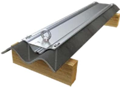
Diese spezielle Anschlageinrichtung für Wellplattendächer kann bereits ab einer Sparrenbreite von 60 x 120 mm verbaut werden. Der ABS-Lock Wave 60 hat eine 125 cm lange Grundplatte und wird mit vier Schrauben an zwei Sparren befestigt. Die ausgelieferte Standardlänge ist dabei auf einen Sparrenabstand (Balkenmitte bis Balkenmitte) von 115 cm ausgelegt.
