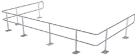
Dem Absturz clever vorbeugen - das Dachgeländer ABS Guard OnTop Sandwich punktet mit einer innovativen Befestigungstechnik. Die Pfosten des hochwertigen Aluminium-Geländers sitzen auf Edelstahl-Grundplatten, die komplett von oben mit wasserdichten Blindnieten auf den Sandwichelementen befestigt werden. Die Dachlast ist auf ein Minimum reduziert, denn zusätzliche Gewichte sind beim ABS Guard OnTop Sandwich nicht erforderlich!
