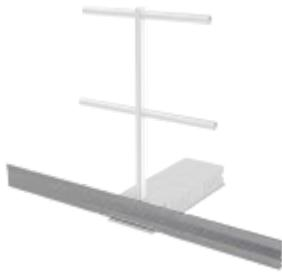
Das ABS Guard Toeboard ist eine 150 mm hohe Fussleiste für unserer Schutzgeländer. Die zusätzliche Fussleiste ist immer dann erforderlich, wenn sich an der Absturzkante keine Erhöhung findet, zum Beispiel in Form einer Attika. Die Leiste ist aus hochwertigem Aluminium gefertigt und wird an den Geländerpfosten befestigt.
