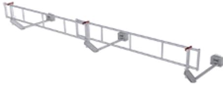
ABS Mobile Guard Flat heißt unser mit Gewichten beschwertes Schutzgeländer für den temporären Einsatz auf Dächern mit einer Neigung von bis zu 10°. Es ist aus robustem, wetterbeständigem Aluminium gefertigt, für den Transport kompakt verstaut und mit wenigen Handgriffen schnell aufgestellt.
