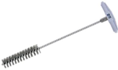
Absturzicherungen wollen sorgfältig installiert sein, damit Sie auch die gewünschte Sicherheit bieten. Dazu gehört auch eine Reinigung der Bohrlöcher in Beton und Mauerwerk, bevor Montagemörtel oder Dübel zum Einsatz kommen. Mit unserer Reinigungsbürste ABS DustBrush entfernen Sie Partikel und Staub im Handumdrehen. Die Bürste ist in 2 Größen für verschiedene Loch-Durchmesser erhältlich: Wählen Sie zwischen  $\varnothing$  20 oder  $\varnothing$  24 mm.
