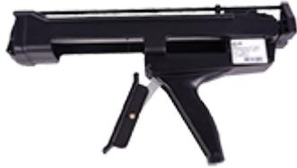
Mit der Auspresspistole WIT pressen Sie während der Montage unseren Verbundmörtel WIT-VM-250 in Bohrlöcher. Sie benötigen dieses System bei der Installation von Anschlagpunkten und Anschlageinrichtungen, die in Beton oder Mauerwerk verklebt werden.
