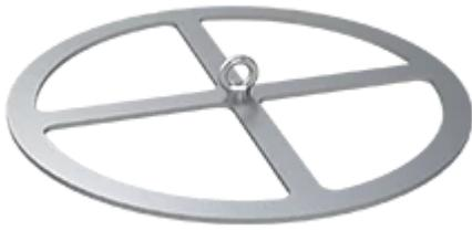
Mit dem ABS-Lock OnTop Control überprüfen Sie die Stabilität von Bitumenflächen und gewebeverstärkter Folie. Dazu werden 2 der mit Ösen versehenen Edelstahlkomponenten auf der Dachoberfläche verschweißt und parallel zur Dachfläche gegeneinander gezogen. Ist die erforderliche Kraft eingeleitet, bricht ein integrierter Kraftmesser zwischen Kettenzug und Kontrollöse. Sollte sich die Dachhaut unerwartet verformen oder aufreißen, bevor der Kraftmesser nachgibt, ist sie nicht tragfähig.
