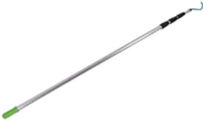
In Hallen, Wartungshangars oder Veranstaltungsgebäuden hängen Höhensicherungsgeräte (HSG) zum Schutz gegen Absturz oft in schwer oder gar nicht erreichbaren Höhen. Mit dem ABS TelePole ziehst Du den Karabinerhaken der Anschlageneinrichtung einfach zu Dir und befestigst so den Auffanggurt Deiner Schutzausrüstung von einem sicheren Standort aus. Auf diese Weise nutzt Du einen über Kopf installierten Anseilschutz und sorgst so für ein Höchstmaß an Sicherheit.
