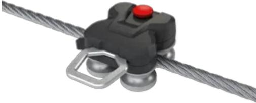
ABS QuattroRoll heißt unser bisher bester Rollengleiter für horizontale Seilsicherungssysteme. Mit seinen vier kugelgelagerten Rollen fährt er perfekt um jede Kurve und passiert reibungslos alle Zwischenstützen. Dabei sitzt er zuverlässig auf dem Stahlseil - der nur beidhändig zu bedienende Schließmechanismus verhindert ein versehentliches oder unbeabsichtigtes Öffnen. Dank einer großzügigen Anschlagöse kann der Rollengleiter mit verschiedenen Karabinerhaken genutzt werden.
