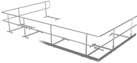
Dank intelligentem Klemmsystem und leichter, robuster Aluminiumkonstruktion ist das ABS Guard OnTop Falz besonders dachschonend. Der Clou an diesem Seitenschutzgeländer: Es ist nicht nur superleicht, sondern erfordert auch keine Dachdurchdringung. Die Klemmen werden einfach fest auf dem Rundbördel- oder Stehfalz verschraubt, und der Seitenschutz sichert Dich zuverlässig auf Dachflächen bis 10° Neigung.
