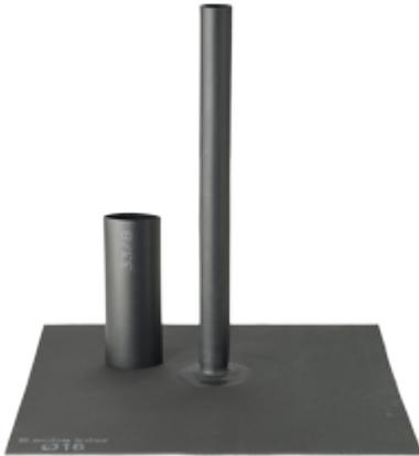
Mit der Abdichtmanschetten AMA Butyl versiegeln Sie Anschlagpunkte und Systemstützen von Seilsicherungssystemen. Diese Manschetten haben eine Länge von 280 mm, die Flanschgrösse beträgt 300 x 300 mm. Die homogen gefertigten Manschetten sind speziell für Bitumendächer konzipiert. Das weiche Material ermöglicht ein einfaches, sauberes kürzen auf die passende Länge.
