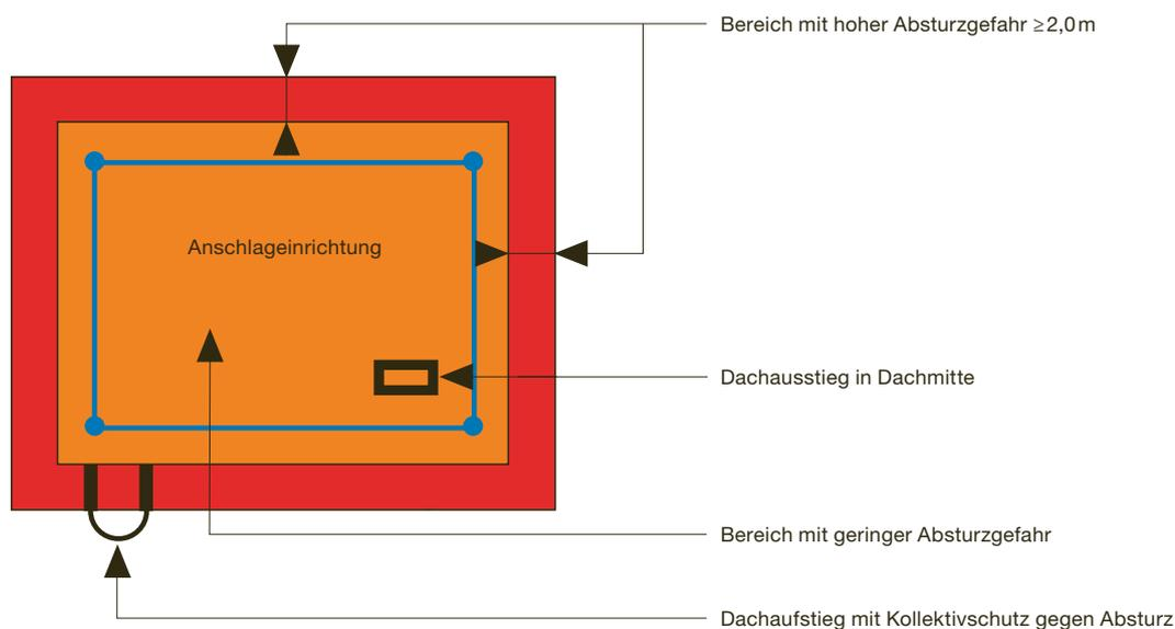
6 Zugangsmöglichkeiten aufs Dach
