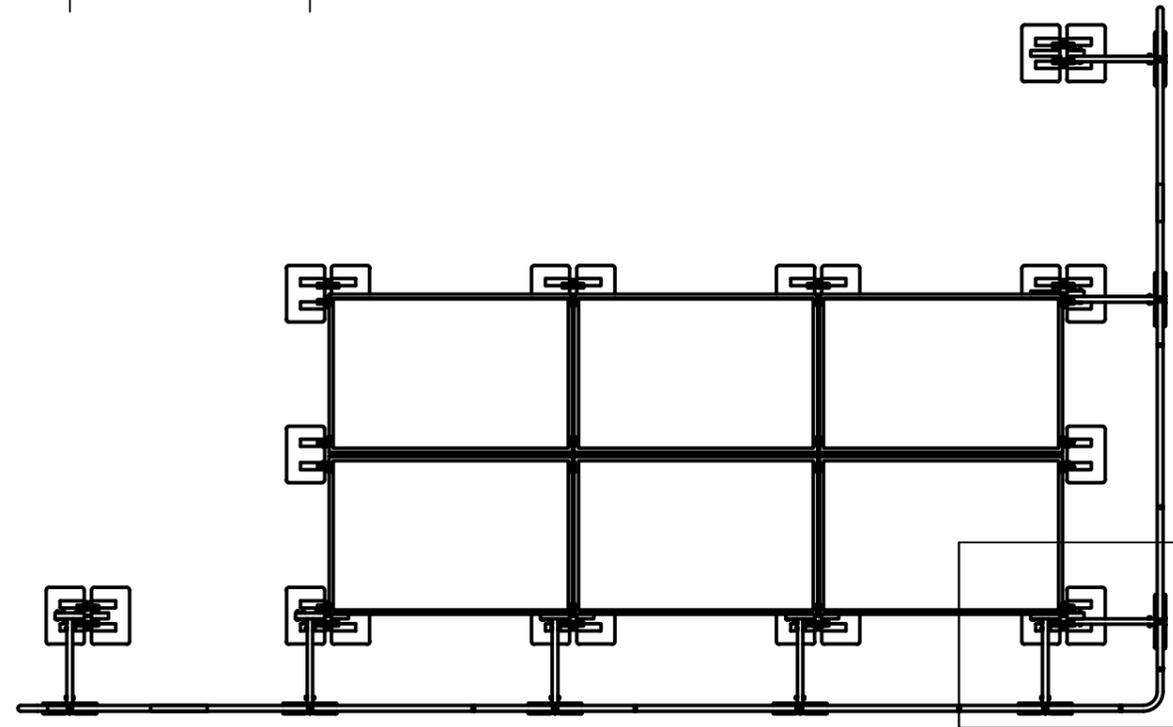
Durch Sonderlängen der Bodenholme lassen sich auch kürzere Abstände realisieren.
