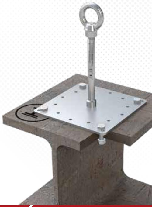
>>> Edelstahl-Anschlagpunkt ( $\varnothing$  16mm) für Stahl, mit Grundplatte (200 x 200mm). 4 Edelstahlschrauben werden durch Bohrlöcher gesteckt und mit Muttern gekontert. Inkl. Befestigungsset aus Edelstahl.
