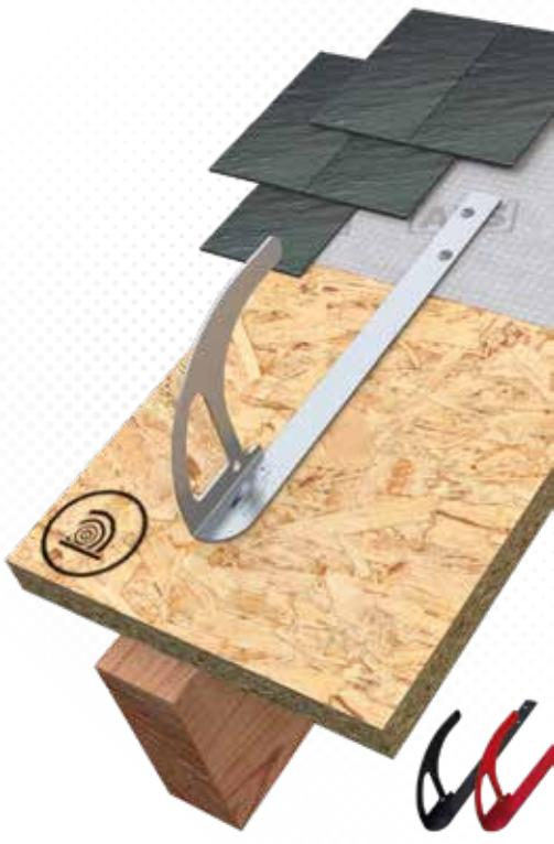
>>> Edelstahl-Sicherheitsdachhaken für Holzsparren, mit flachem Holm für durchgängige Schalung. Befestigung mit 2 Edelstahlschrauben durch Konterlattung/Schalung im Sparren. Bei Montage durch Aufsparrendämmung Spezialschrauben erforderlich. Auch in Rot (R), Anthrazit (A) oder Sonderfarben (X) erhältlich. Inkl. Befestigungsset.
