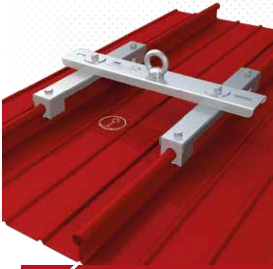
>>> Edelstahl-Anschlagpunkt mit Aluminiumklemmen. Wird durchdringungsfrei auf Rundbördelfalz geklemmt. Inkl. Befestigungsset.
