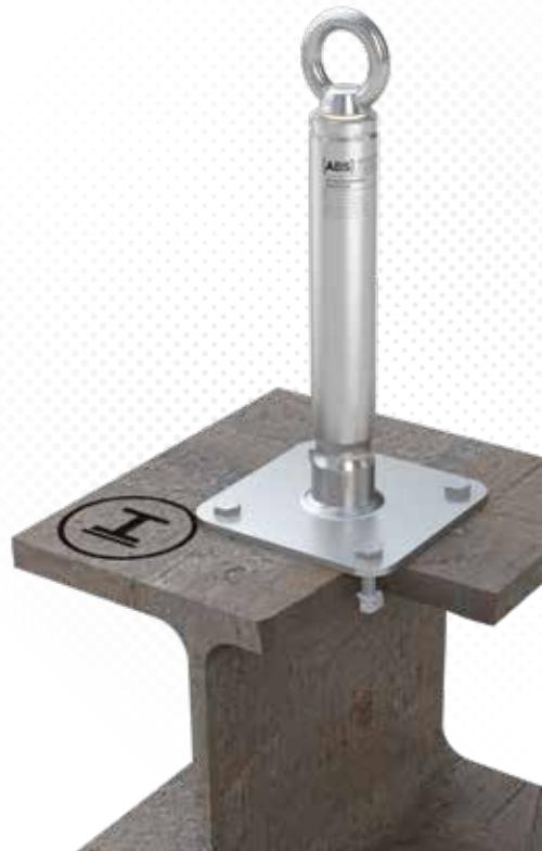
>>> Edelstahl-Anschlagpunkt für Stahl, mit Grundplatte (150 x 150mm) und verschweißtem Stützrohr ( $\varnothing$  42mm). 4 Edelstahlschrauben werden durch Bohrlöcher gesteckt und mit Muttern gekontert. Inkl. Befestigungsset aus Edelstahl.
