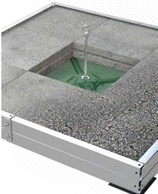
>>> Anschlagkreuz für Flachdächer, mit 16 Betonplatten (50 x 50 x 5cm) oder Kies beschwert (nicht im Lieferumfang). Hochwertiger Edelstahl-Rahmen (150 x 150cm) mit Aluminiumquerstreben und zentralem Edelstahl-Anschlagpunkt (Ø 16mm). Gesamtgewicht 483kg (mit Betonplatten) oder 485kg (mit Kies). Inkl. Befestigungsset aus Edelstahl und 5 EPDM-Patches zum Schutz der Dachhaut.
