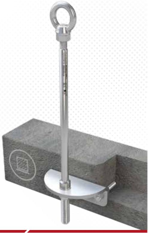
>>> Edelstahl-Anschlagpunkt ( $\varnothing$  16mm) für Beton, seitliche Montage mit Winkelplatte. 2 Ankerstangen (250mm) werden mit Verbundmörtel WIT-VM-250 (ZU-1000) im Beton befestigt. Inkl. Befestigungsset aus Edelstahl.
