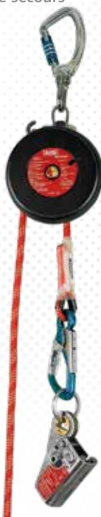
>>> Aufgefangene Personen sicher retten: Mit diesem handlichen und kompakten Rettungsgerät werden ver- unfallte Personen angehoben und nach dem Lösen des Anseilschutzes sicher zu Boden gelassen (Abseilgeschwin- digkeit: 0,8 m/s). Wartungsarme Einlagerung bis 10 Jahre möglich.
