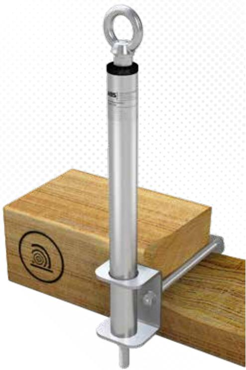
>>> Edelstahl-Anschlagpunkt ( $\varnothing$  16mm) mit Stützrohr ( $\varnothing$  42mm) für Holz, seitliche Montage mit Winkelplatte. 2 Gewindestangen (250mm) werden durch Bohrlöcher gesteckt und mit Muttern gekontert. Inkl. Befestigungsset aus Edelstahl.
