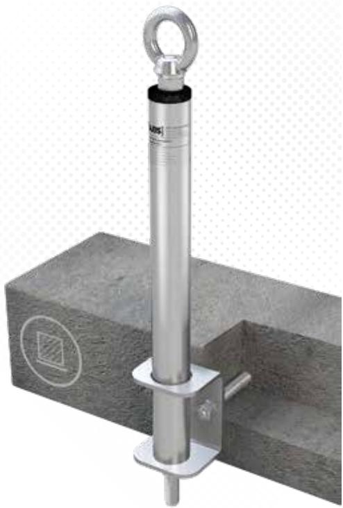
>>> Edelstahl-Anschlagpunkt ( $\varnothing$  16mm) mit verschraubtem Stützrohr ( $\varnothing$  42mm) für Beton, seitliche Montage mit Winkelplatte. 2 Ankerstangen (250mm) werden mit Verbundmörtel WIT-VM-250 (ZU-1000) im Beton befestigt. Inkl. Befestigungsset aus Edelstahl.
