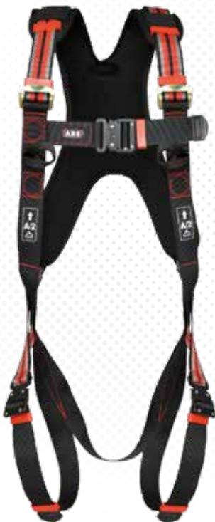
>>> Komfortabler und angenehm leichter Auffanggurt (Einheitsgröße), kann individuell eingestellt werden. 2 Auffangschlaufen im Brustbereich und ein D-Ring im Rückenbereich zur Anbringung geeigneter Verbindungsmitte, z.B. mitlaufendes Auffanggerät ABS Lanyard oder zur Verwendung mit Steigschutzsystemen, z.B. ABS SafetyHike.
