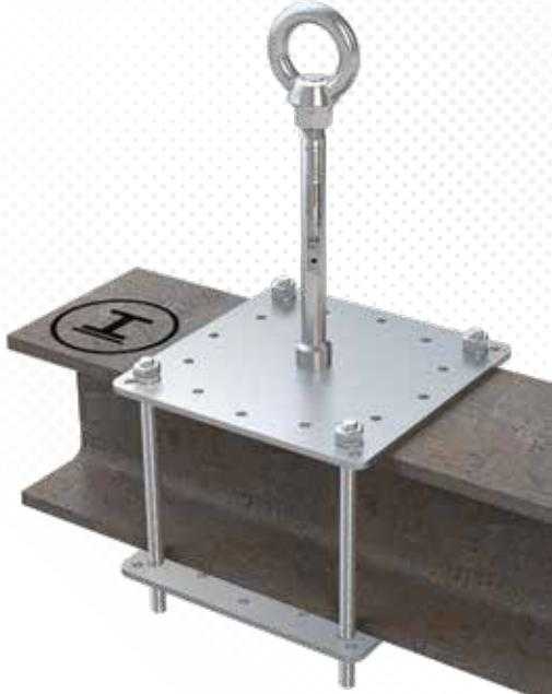
>>> Edelstahl-Anschlagpunkt ( $\varnothing$  16mm) für Stahlträger, mit Grund- und Konterplatte (200 x 200mm). Wird um Träger geklemmt, Trägerbreite max. 150mm. Sondermaße auf Anfrage. Inkl. Befestigungsset aus Edelstahl.
