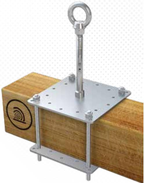
>>> Edelstahl-Anschlagpunkt ( $\varnothing$  16mm) für Holzbalken, mit Grund- und Konterplatte (200 x 200mm). Wird um Träger geklemmt, Trägerbreite max. 150mm. Sondermaße auf Anfrage. Inkl. Befestigungsset aus Edelstahl.
