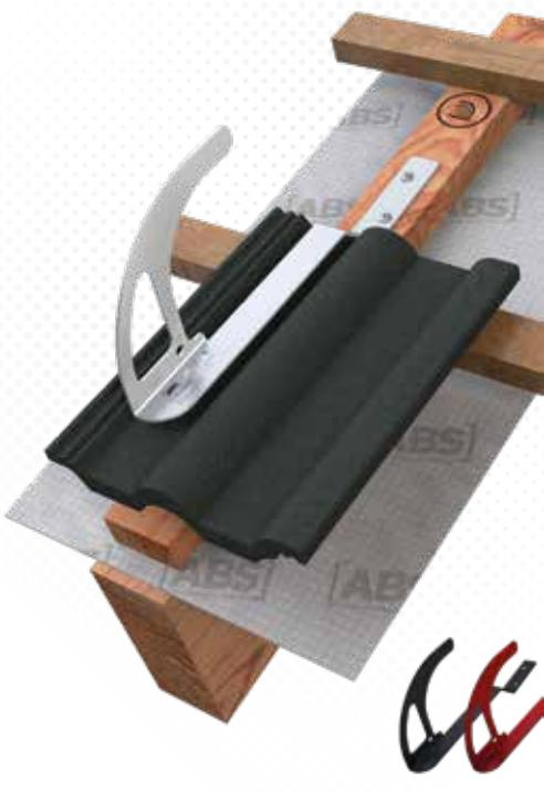
>>> Edelstahl-Sicherheitsdachhaken speziell für Ziegeldächer. Montage auf Holzsparren, mit gekröpftem Holm zur Überbrückung der Dachlattung. Befestigung mit 2 Edelstahlschrauben durch Konterlattung im Sparren. Auch in Rot (R), Anthrazit (A) oder Sonderfarben (X) erhältlich. Inkl. Befestigungsset.
