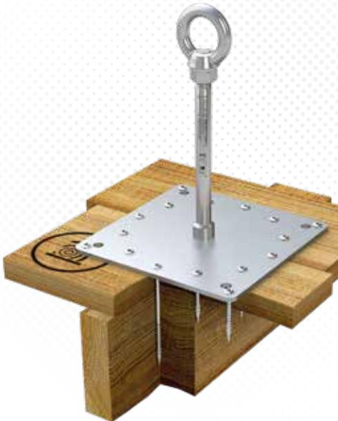
>>> Edelstahl-Anschlagpunkt ( $\varnothing$  16mm) für Holz, mit Grundplatte (200 x 200mm). Mit 16 Edelstahlschrauben auf Holzschalung und Sparren verschraubt (2 lange Schrauben im Balken). Inkl. Befestigungsset.
