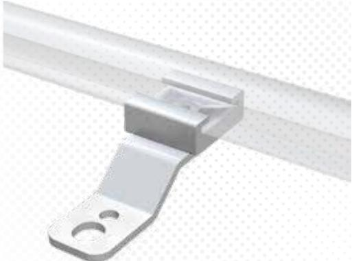
>>> Aluminium-Zwischenhalter für Schienensicherungssystem ABS AluTrax, zur Montage auf Beton oder Stahl. Loslager für temperaturbedingte Ausdehnung. Inkl. Befestigungsset.
