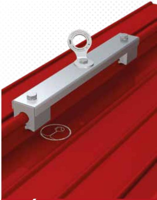
>>> Edelstahl-Anschlagpunkt mit Aluminiumklemmen. Wird durchdringungsfrei auf Rundbördelfalz geklemmt. Besonders unauffällig. Inkl. Befestigungsset.
