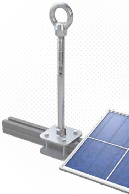
>>> Edelstahl-Anschlagpunkt ( $\varnothing$  16mm) für Solarthermie- und PV-Module, mit Grund- und Konterplatte (100 x 100mm). Wird um Träger geklemmt. Inkl. Befestigungsset aus Edelstahl.
