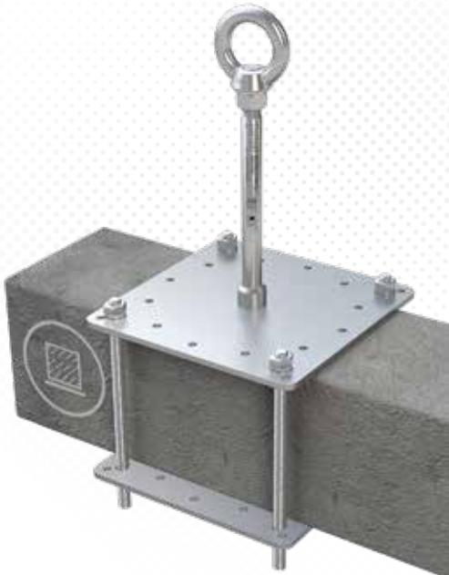
>>> Edelstahl-Anschlagpunkt ( $\varnothing 16\text{mm}$ ) für Betonträger, mit Grund- und Konterplatte (200 x 200mm). Wird um Träger geklemmt, Trägerbreite max. 150mm. Sondermaße auf Anfrage. Inkl. Befestigungsset aus Edelstahl.
