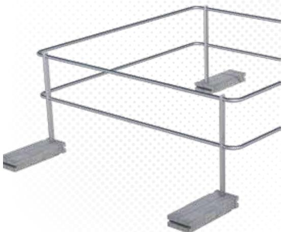
>>> Hochwertiges Schutzgeländer aus Aluminium und Edelstahl für Lichtkuppeln auf Flachdächern bis 10° Neigung. Durchdringungsfreie Montage mit Betongewichten (Anthrazit). Höhe des Handlaufs: 1100mm. Inkl. Befestigungsset.
