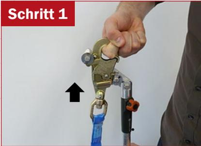
Spezialkarabiner von unten an die Spezialkonstruktion anlegen.
