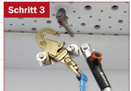
Spezialkarabinerhaken vom Anschlagpunkt entfernen.
