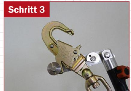
Ist der Spezialkarabiner korrekt arretiert, bleibt er automatisch offen.
