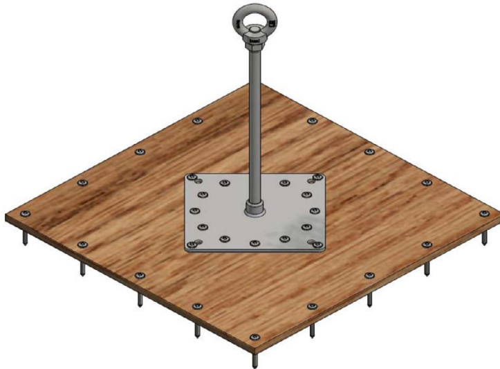
Abbildung 4 - Verstärkungsplatte 500 x 500 aus OSB3 \geq 12 mm mit 16 Schrauben
