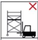
Heben Sie die fahrbare Arbeitsbühne nicht mit mechanischen oder elektrischen Geräten an.
