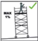
Die fahrbare Arbeitsbühne muss mittels Nivellierspindeln vertikal ausgerichtet werden. Die maximale Neigung darf 1 % nicht überschreiten.
