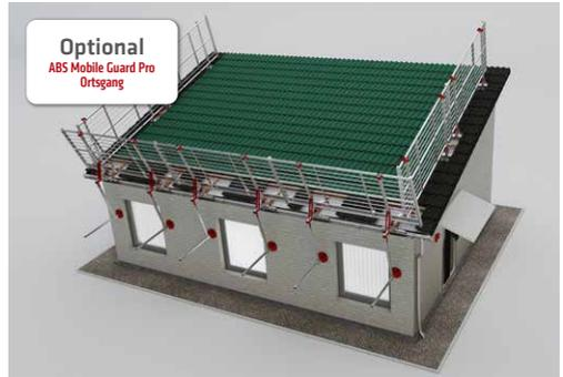
Das ABS Mobile Guard Pro ist als vorübergehende Randsicherung für Arbeitsplätze und Verkehrswege entsprechend den Forderungen in EN 13374 für Dachneigungen bis 60° geeignet.
